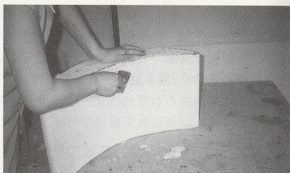
图201 用砂纸将笨板造型打磨光滑
