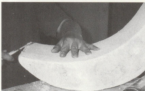
图200 用刀将苯板削成所设计的造型
